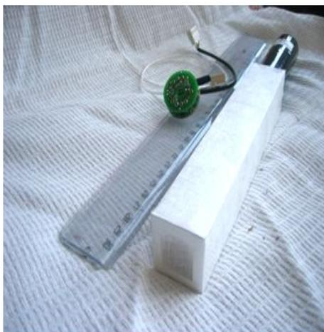
Рис. 7. Счетчик с делителем и предварительным усилителем.
