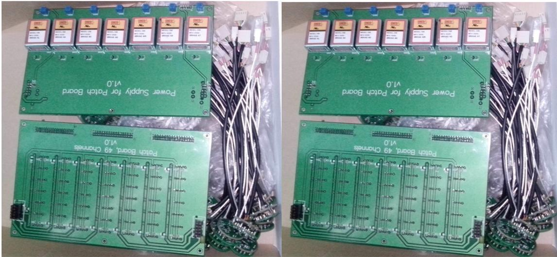
Рис. 8а. Лицевая сторона плат: сверху внешняя плата – делители, внизу – внутренняя плата. Видны 49 разъемов для подключения панелей ФЭУ.
