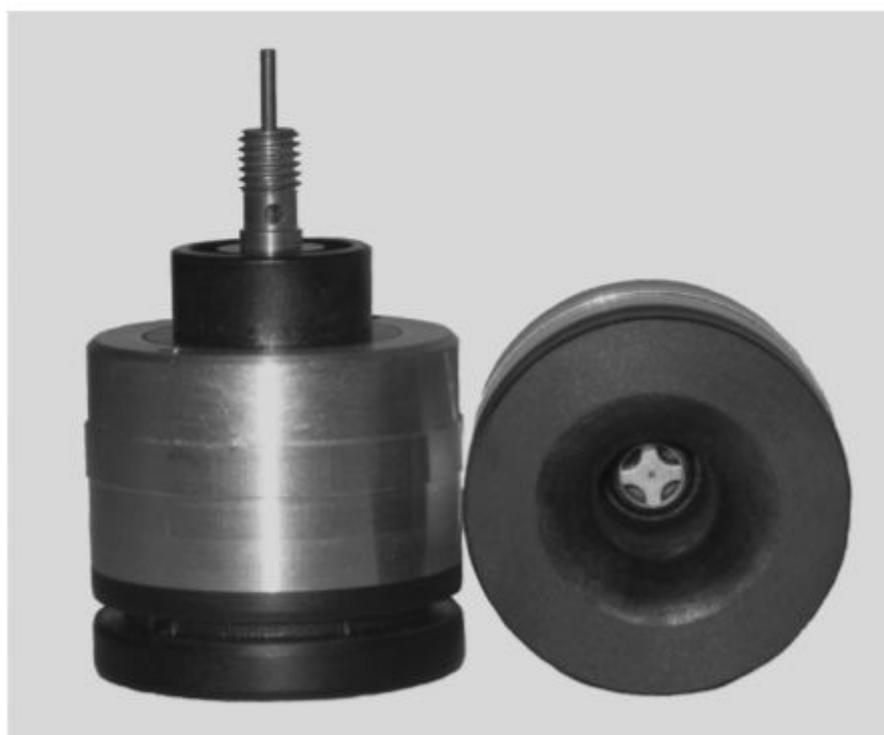
Рис. 3. Торцевые заглушки дрейфовых трубок
