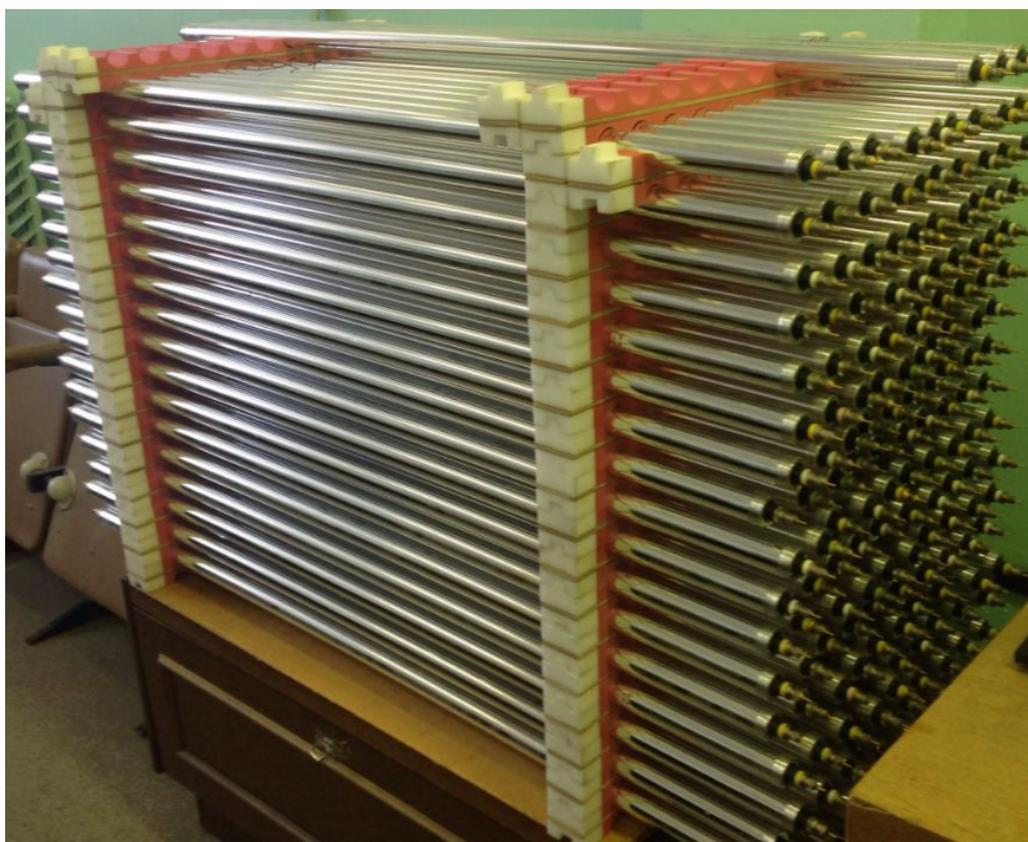
Рис. 5. Готовые дрейфовые трубки
