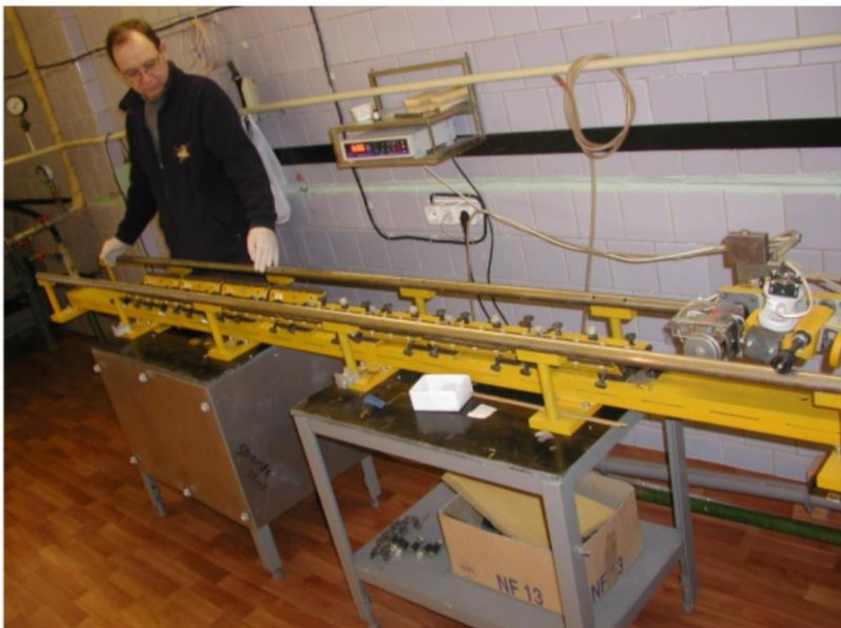
Рис. 4. Фотография станда ультразвуковой сварки лавсановых корпусов дрейфовых трубок
