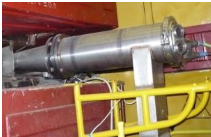
Рисунок 3.1 – Общий вид установленной на ускорителе станции с изогнутыми кристаллами [4]
