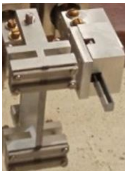
Рисунок 1.5 – Внешний вид кристаллов в держателях: кристалл – полоска (слева) и О-кристалл (справа)
