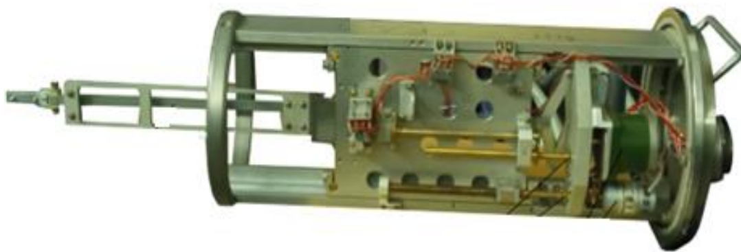
Рисунок 2.1 – Станция кристаллических дефлекторов с одной кареткой [1]
