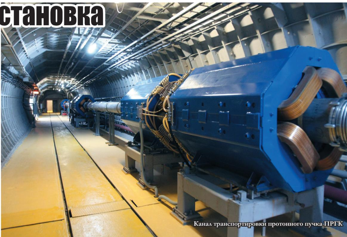
Канал транспортировки протонного пучка ПРГК
