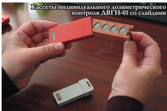
Кассеты индивидуального дозиметрического контроля ДВГН-01 со слайдами
