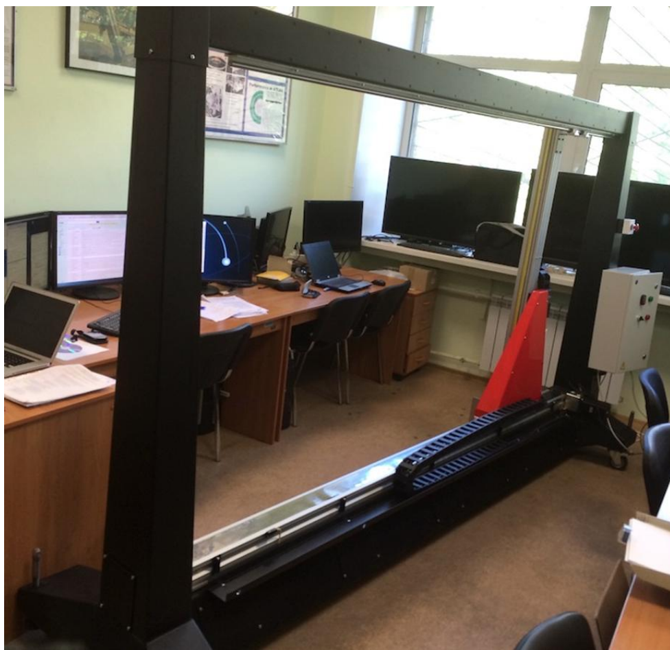
Рисунок 28 - Лабораторный образец рентгеновского сканера (РС) тип 1.
