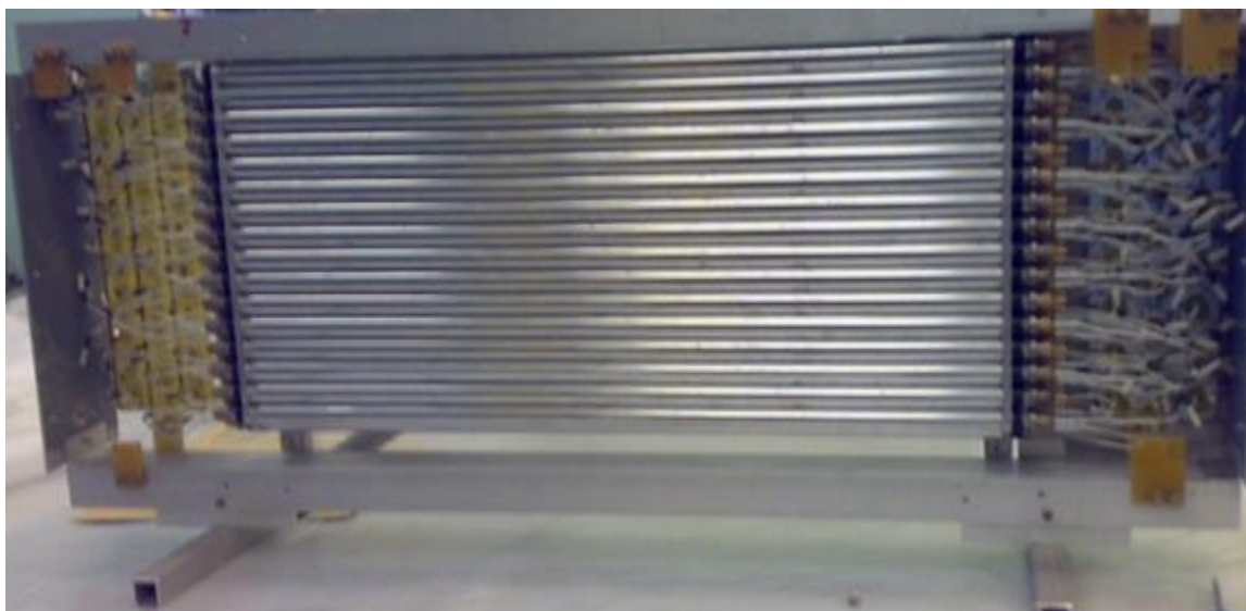
Рисунок 38 - Фотография экспериментальной мюонной камеры.
