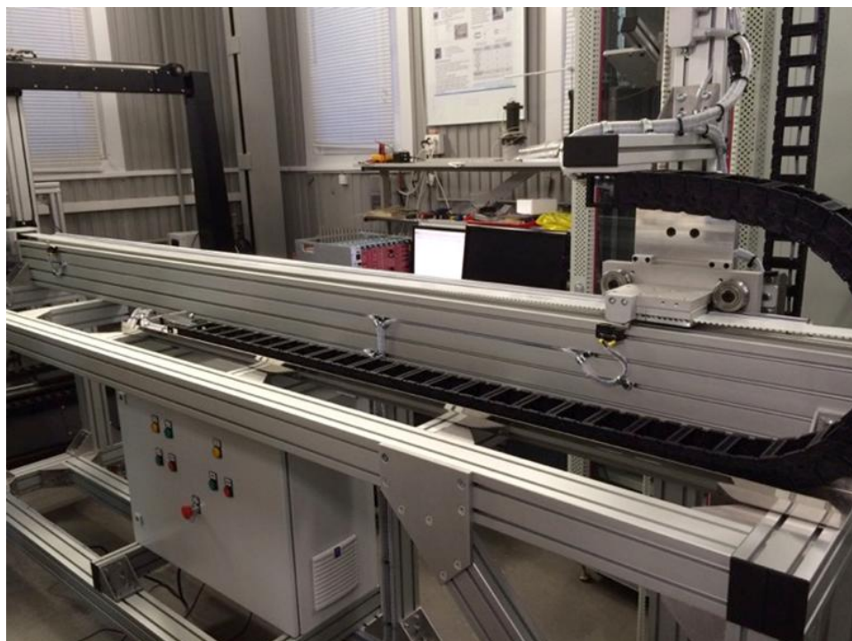
Рисунок 31 - РС типа 2 до модернизации. Длина 3340 мм, область сканирования 2300x1450 мм.
