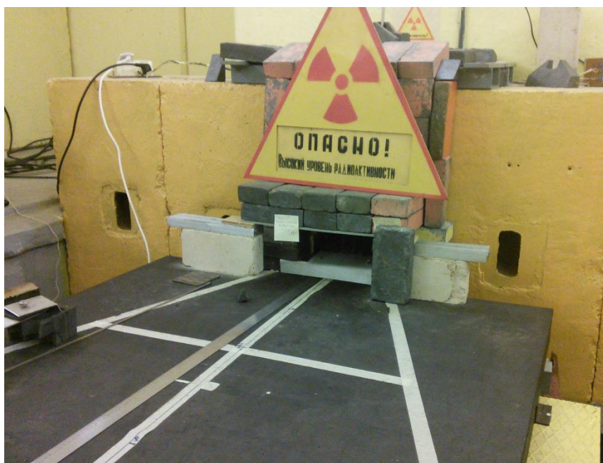
Рисунок 44 - Облучательная установка PANDA RS.
