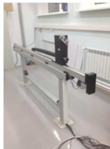
Рисунок 7 - Машина для намотки анодных проволок, которая состоит из вращающегося стола, с вакуумной откачкой для прижима катодных плоскостей (слева), и натяжного устройства (справа).
