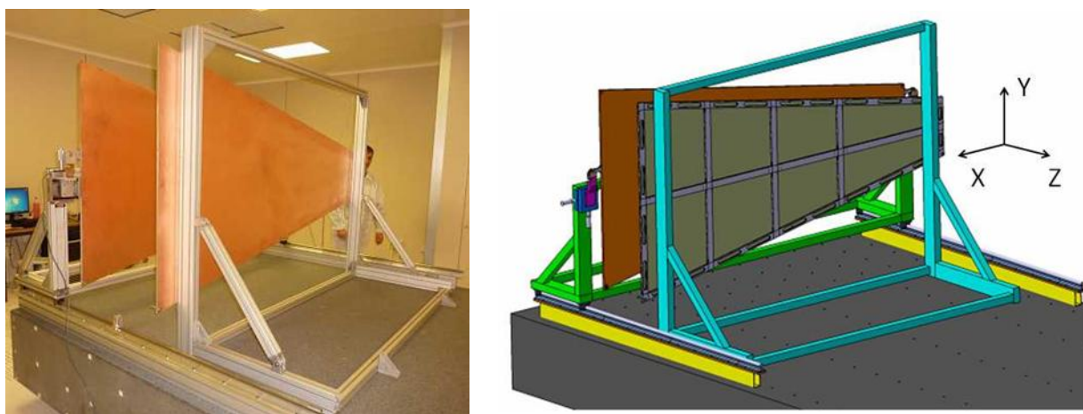
Рисунок 18 - Механическое устройство для сборки квадруплета МИК.
