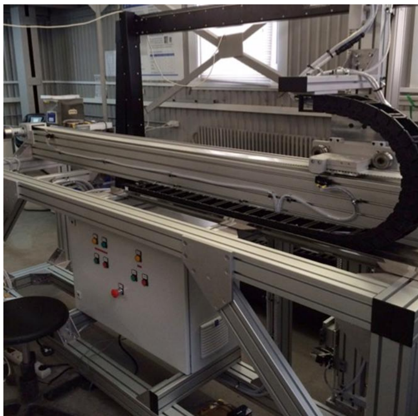
Рисунок 32 - Сканер типа 2 после модернизации. Длина 2500 мм, область сканирования 1750x1450 мм.
