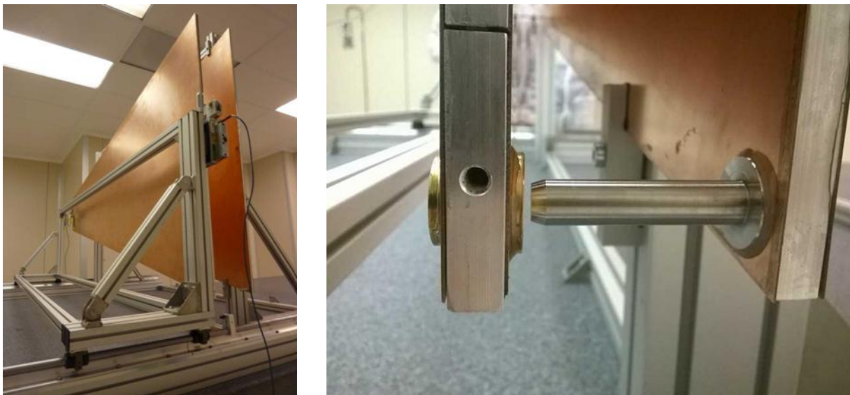
Рисунок 22 - Соединение двух МИК. Справа - первая дрейфовая панель.
